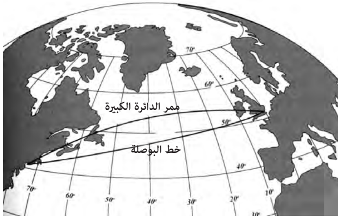
الشكل (209): ممر الدائرة الكبيرة من مدينة نيويورك إلى لندن بالمقارنة مع خط البوصلة.
